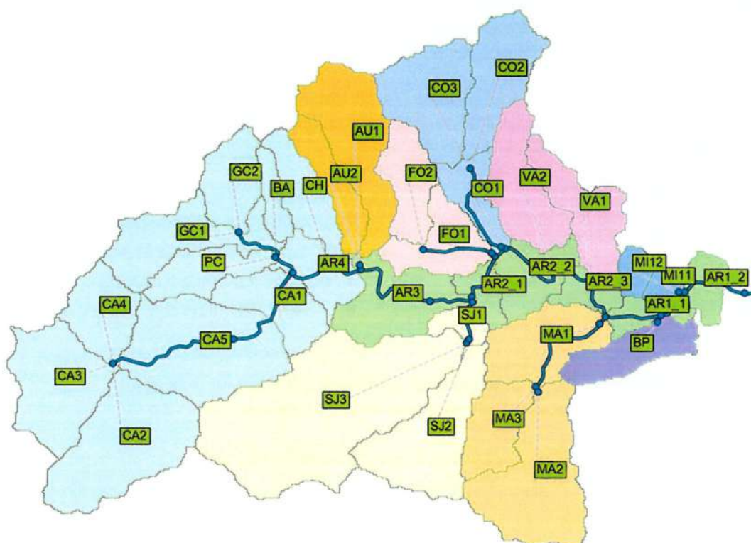
Figure 31 : Structure du modèle hydrologique du bassin versant du Riou de l'Argentière
